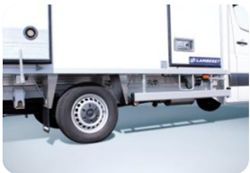
Anpassung auf Fahrgestell aus Aluminium
