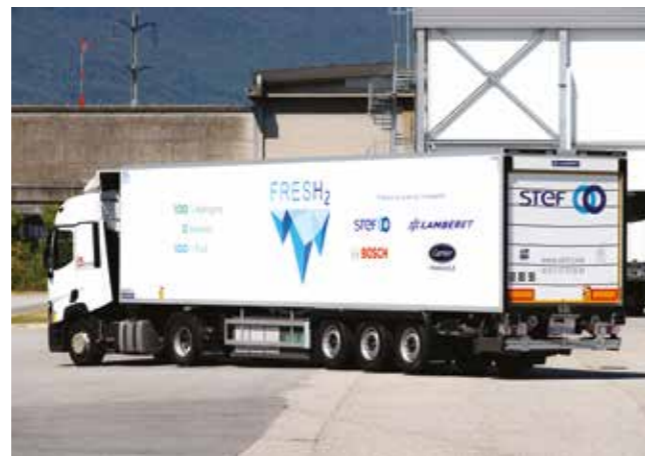
Die Tests unter realen Bedingungen mit dem STEF-Transporter sind überzeugend: Dank der direct PAC H2- Technologie von BOSCH ist es möglich, Multi-Temperatur-Verteilerfahren über die ganze Zeit hinweg zu gewährleisten.
